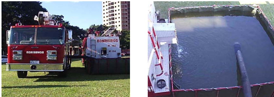
Fig. 55 e 56 – Tanque portátil pronto para operação
