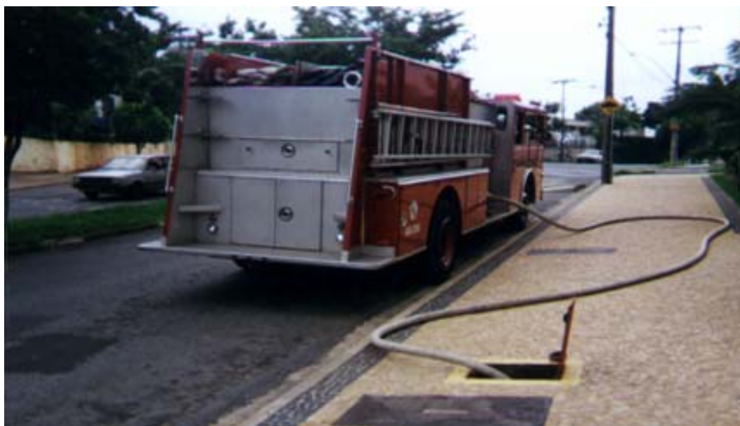
Fig. 38 – Suprimento de Água através de um registro recalque
