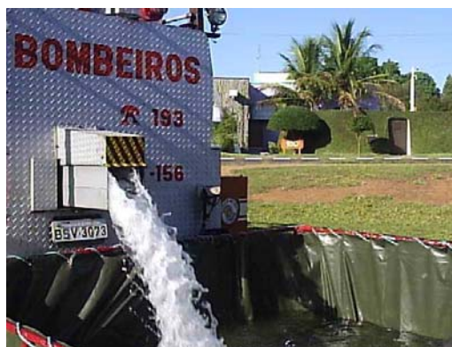
Fig. 54 – Detalhe de enchimento através de válvula de dilúvio
