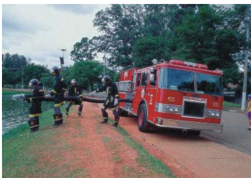
Fig. 36 – Suprimento de Água através de manancial para AB
