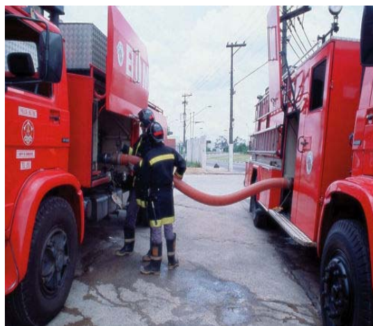
Fig. 33 – foto de suprimento de água AT para AB
