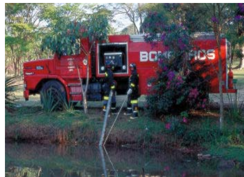
Fig. 36 – Suprimento de Água através de manancial para AB
