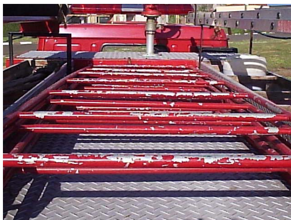
Figura 41 – Estrutura do tanque portátil acondicionada no berço do Auto Tanque.
