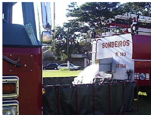
Fig. 50 e 51 – Enchimento através de válvula de dilúvio
