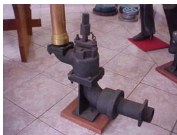
Fig. 10 – Hidrante Urbano Subterrâneo
