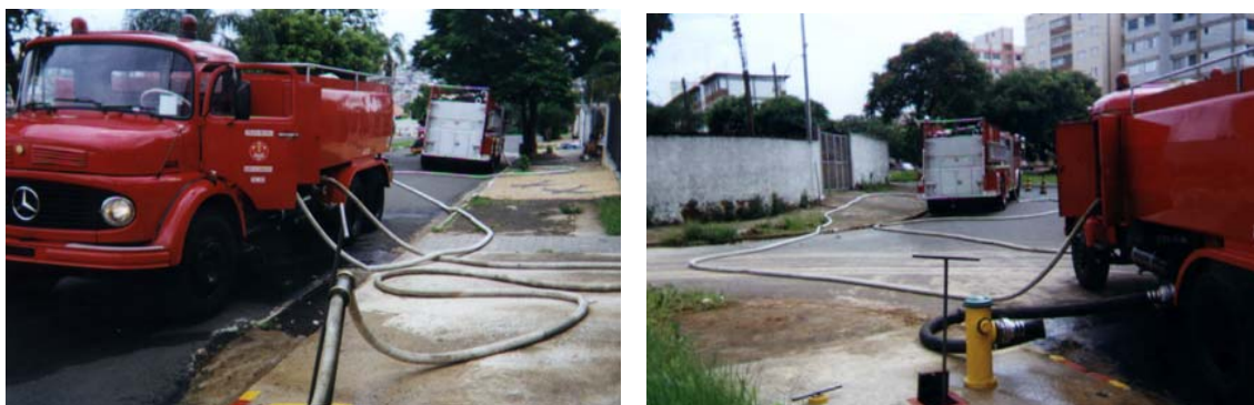
Fig. 34 – Esquema de abastecimento a longa distância do hidrante
