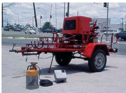
Fig 31 – Moto Bomba e Bomba Submersível
