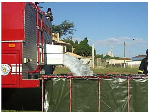
Fig. 50 e 51 – Enchimento através de válvula de dilúvio
