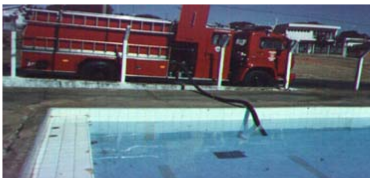
Fig. 35 – Suprimento de Água através de uma piscina para AB
