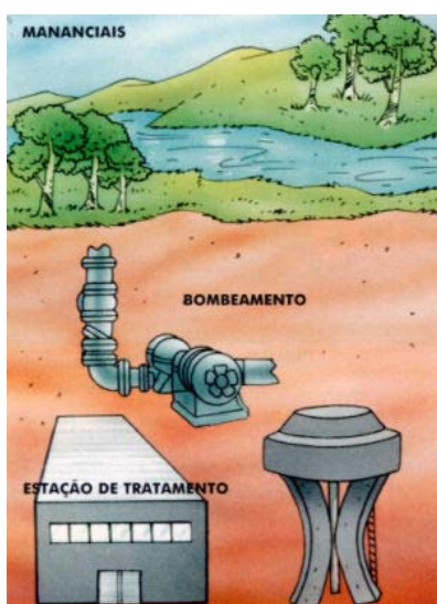
Fig. 65 Sistema de Abastecimento em Cidades
